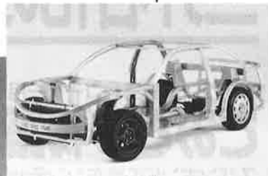
自動車の軽量化 アルミスペースフレーム
