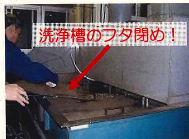
洗浄槽のフタをすると蒸発量が1/2～1/4程度まで減ります。 (東京都VOC対策ガイド(工場内編)より)
